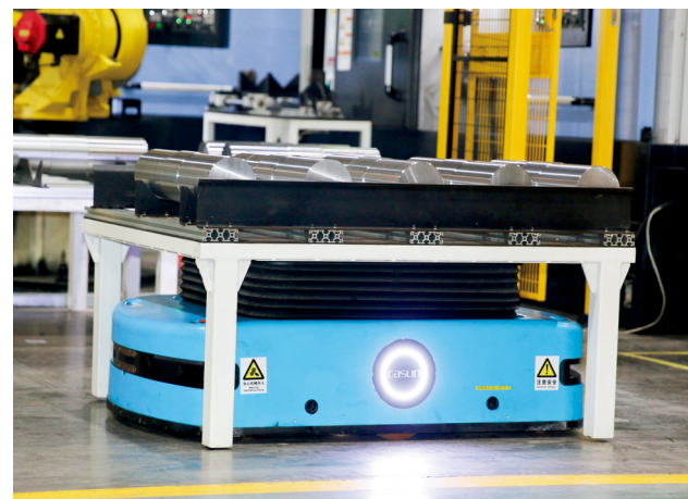
AGV 智能搬运机器人 AGV Intelligent Handling Robot
